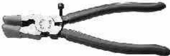
32 115 00 PROVETRO Laufzange / Running pliers PRP-1 Metall, 205 mm L., 24 mm Backenbreite, mit Stellschraube, Griff und Backen ummantelt, (ideal für 2 - 6 mm Glas) Metal, 205 mm, 24 mm jaw width, leveling screw, coated grip and jaw
